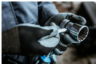
À l'aide de l'extracteur de douille (article 1111), enfoncez la goupille dans le trou tout en retirant la douille du carré du cliquet, puis changez la douille ou la rallonge
