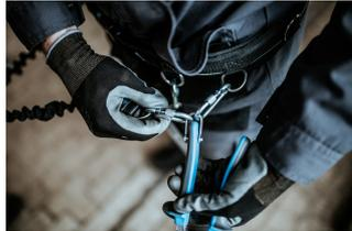
Der Karabiner am Umhängeband ist mit Schraubssicherung gegen Öffnen zu sichern.
