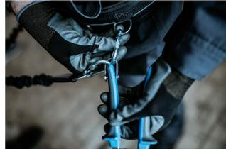
Vor Abnehmen des Werkzeugs vom Gürtel ist die Schraubssicherung am Karabiner am Gürtel zu öffnen.
