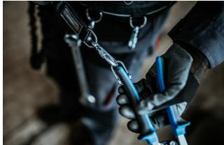
Slika prikazuje pravilno kačenje alata za vezni element. Okačite alat za pojus, idući koracima u obrtnutom redosledu.
