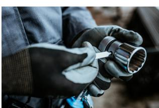
Koristeći se izbjigačem nasadnih ključeva (art. 1111) pritisnite pin u rupi i skinite ključ sa čegrtaljke, a zatim stavite drugi ključ ili produžetak.
