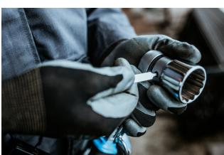
Koristeći se izbjigačem nasadnih ključeva (art. 1111) pritisnite pin u rupi i skinite ključ sa čegrtaljke, a zatim stavite drugi ključ ili produžetak.
