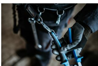
Slika prikazuje pravilno kačenje alata za vezni element. Okačite alat za pojас, idući koracima u obrnutom redosledu.
