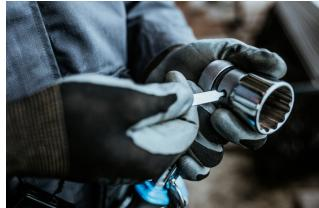
Koristeći se izbjigačem nasadnih ključeva (art. 1111) pritisnite pin u rupi i skinite ključ sa čegrtaljke, a zatim stavite drugi ključ ili produžetak.
