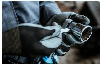
Pomocí odstraňovače nástrčných klíčů (článek 1111) zatlačte na kolík v otvoru, vyjměte nástavec ze čtyřhranu ráčny a poté ráčnu nebo nástavec přepněte.
