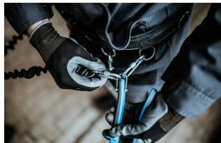
Карабинот на ременот треба да биде заштитен од отворање со помош на прстен за заклучување.
