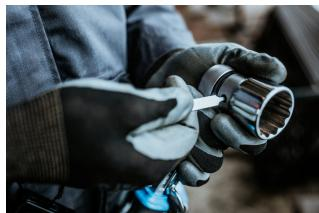
Pomocí odstraňovače nástrčných klíčů (článek 1111) zatlačte na kolík v otvoru, vyjměte nástavec ze čtyřhranu ráčny a poté ráčnu nebo nástavec přepněte.
