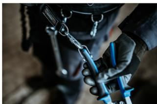
Slika prikazuje pravilno kačenje alata za vezni element. Okačite alat za pojas, idući koracima u obrnutom redosledu.
