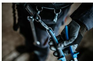
Slika prikazuje pravilno kačenje alata za vezni element. Okačite alat za pojaz, idući koracima u obrtnutom redosledu.
