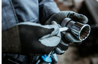
Koristeći se izbijačem nasadnih ključeva (art. 1111) pritisnite pin u rupi i skinite ključ sa čegrtaljke, a zatim stavite drugi ključ ili produžetak.
