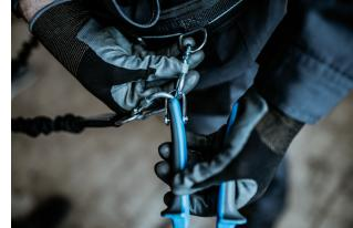
Prije skidanja alata s remena, odvrnite maticu na karabineru.
