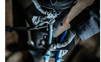
Otkopčajte karabiner na remenu i uklonite alat pričvršćen za užicu. Alat je sada spremjan za rad.
