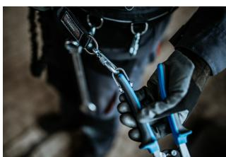
Slika prikazuje pravilno kačenje alata za vezni element. Okačite alat za pojus, idući koracima u obrnutom redosledu.
