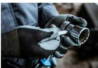
Koristeći se izbjiačem nasadnih ključeva (art. 1111) pritisnite pin u rupi i skinite ključ sa čegrtaljke, a zatim stavite drugi ključ ili produžetak.
