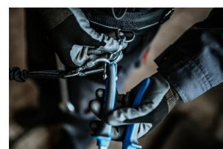
Otkopčajte karabiner na remenu i uklonite alat pričvršćen za užicu. Alat je sada spremjan za rad.
