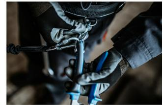
Ouvrir le mousqueton de la ceinture et sortir l'outil qui est attaché à la lanière, du mousqueton de la ceinture. L'outil est maintenant prêt à l'usage.
