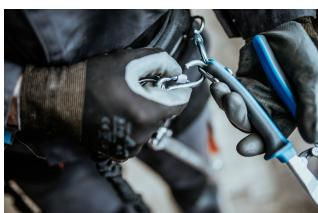
Karabina na lanku je připevněna ke kroužku na nářadí. Kroužky na nástrojích jsou dostatečně velké, aby pojaly 2 karabiny.
