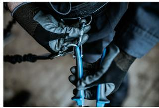
Antes de retirar la herramienta del cinturón, desenrosque el anillo de bloqueo del mosquetón del cinturón.
