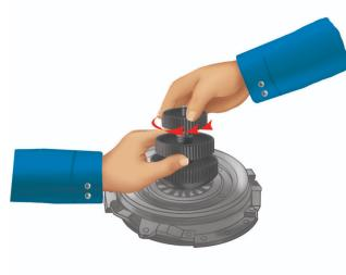
fiksirajte položaj točkića (2), i istovremeno okrećite najmanji točkić (1) i sve dok se ne pričvrsti konusni deo alata u centru lamele
