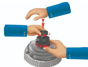
postavite kvačilo na zamajac motora i fiksirajte ga. Odvrnite najmanji točkić (3). Zatim potpuno odvrnite najveći točak (1) i potisnite da oslobođite konusni deo. Uklonite alat sa kvačila.
