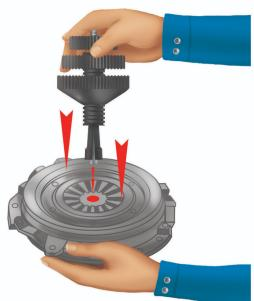
oslobodite najveći točkić (3) i okrećite ga dok ne dodirne točkić (2). Održavajući položaj regulacionog vijka, odvrnite najmanji točkić (1) i dovedite ga da se osloni na točkić (2). Postavite alat u centar lamele kroz korpu kvačila i pritisnite.
