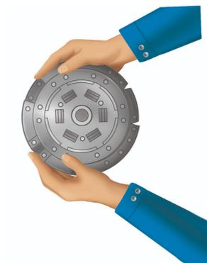
Вручную отцентрируйте диск на корзине сцепления.
