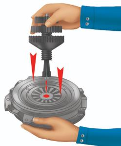
Поворачивайте конусный диск (3), пока он не коснется ручки (2). Оставляя неподвижным регулировочный винт, отвинтите ручку (1) и удерживайте её напротив ручки (2).
