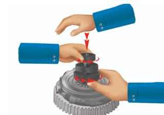
Поместите сцепление на маховик двигателя и зафиксируйте его. Отвинтите конусный диск (3). Полностью вывинтите ручку (1) и нажмите для освобождения конусного диска. Удалите приспособление из сцепления.
