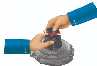
Mantenere la manopola (2) in posizione, ruotare la manopola (1) e bloccare il cono di espansione nel centro del disco frizione.
