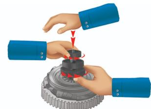
Setzen Sie die Kupplung an die Motorschwungscheibe. Lösen Sie den Griff (3). Schrauben Sie den Griff vollkommen ab und lösen Sie durch Drücken den Dehnkegel. Entfernen Sie das Werkzeug von der Kupplung.
