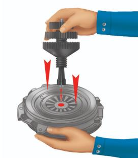
Drehen Sie den Griff (3), bis dieser den Griff (2) berührt. Schrauben Sie den Griff (1) ab bis zum Anschlag an den Griff (2) und bewegen Sie hierbei nicht die Stellschraube. Setzen Sie das Werkzeug durch die Druckplatte in die Mitte der Kupplung und drücken Sie es hinunter.
