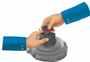
Tout en maintenant le bouton moleté (2) en place, tourner le bouton moleté (1) pour bloquer le cône expansible dans le centre du disque d'embrayage.
