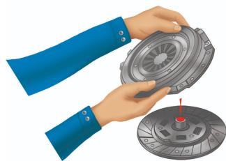
Positionner l'assiette ressort sur le disque d'embrayage.
