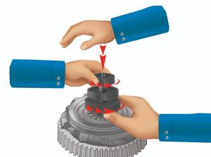
Positionner l'embrayage sur le volant moteur et le fixer solidement.
