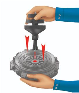
Gire la perilla (3) hasta que toque la perilla (2). Manteniendo el tornillo regulador quieto, desatornille la perilla (1) y apóyela en la perilla (2). Inserte el dispositivo en el medio del disco de cambios, pasándolo a través del plato de resorte y presi
