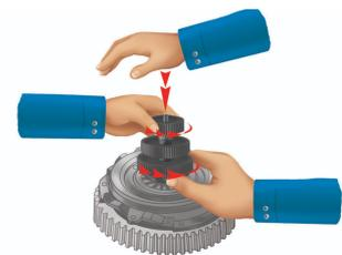
Coloque el embrague en el volante del motor y ajústelo. Desatornille la perilla (3). Desatornille completamente la perilla (1) y presione para liberar el cono expandible. Remueva la herramienta del embrague.
