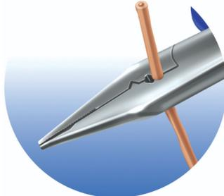
Снятие изоляции диаметром от 3,5 до 4,0 мм.
