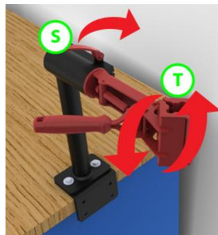
Nastaviti kot glave stojala in varno vpeti kolo? Za nastavitev kota glave stojala sprostite zapenjalec (S) in nastavite želeno pozicijo (T) glave.
