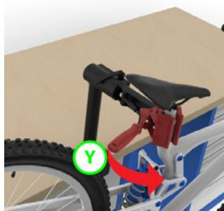
Varno sprostiti kolo iz stojala? Trdno primite okvir kolesa. Obrnite ročaj (Y) za hitro sprostitev cevi iz čeljusti orodja.
