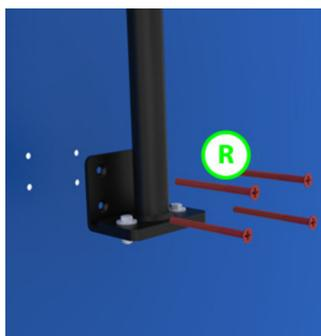
Namestiti stojalo na steno? Za montažo stojala na zid, pripravite luknje s svedom velikosti 10mm in uporabite priložene stenske vložke in vijake (R).
