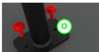
Namestiti stojalo na lesen delovni pult? Za montažo na lesen pult, pripravite luknje s svedom 6mm in uporabite priložene vijake (O) kot prikazuje slika.
