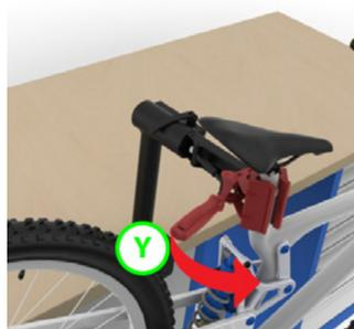
Varno sprostiti kolo iz stojala? Trdno primite okvir kolesa. Obrnite ročaj (Y) za hitro sprostitvev cevi iz čeljusti orodja.
