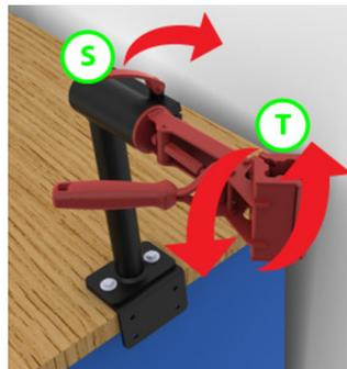
Ajuste el ángulo de las mordazas y sujete la bicicleta con seguridad? Para ajustar el ángulo de la mordaza del portabicicletas, suelte la palanca (S) y ajuste/gire (T).
