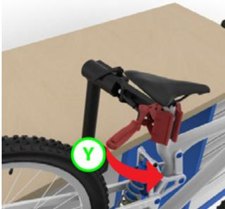
Fahrrad aus dem Ständer nehmen? Zum Herausnehmen den Fahrradrahmen gut festhalten, den Griff (Y) umlegen und Rahmenrohr zügig aus der Klemme ziehen.
