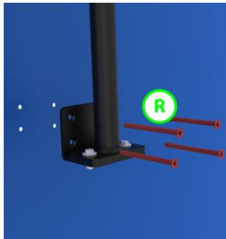
Den Ständer an der Wand aufhängen? Zur Wandmontage des Ständers Bohrungen mit Durchmesser 10 mm vorbohren und die beiliegenden Schraubanker und Schrauben (R) verwenden.
