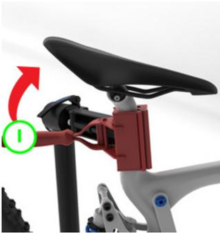
Fahrrad sicher aus dem Ständer nehmen? Zum Herausnehmen den Fahrradrahmen gut festhalten, den Griff (I) umlegen und Rahmenrohr zügig aus der Klemme ziehen.
