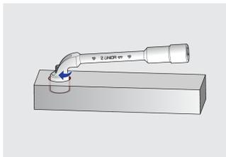
Форма ключа позволяет работать с удлиненными шпильками.
