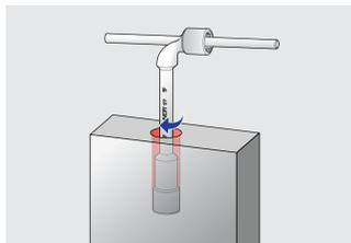
Благодаря глубокому профилю ключ может работать в углублении и с удлиненными шпильками.
