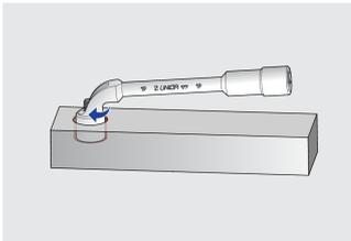
Die spezielle Form und Öffnung des Schlüssels ermöglichen das Verschrauben von Muttern auf langen Gewinden.
