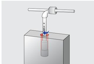
Mit seinem tiefen Profil funktioniert der Schlüssel bei langen Schrauben und Gewinden auch als Steckschlüssel.
