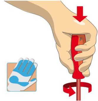
Große Handkontaktfläche = mehr Drehkraft
