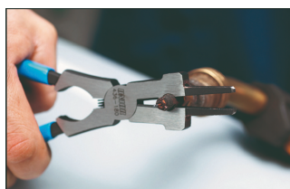
Demontaža in montaža notranje šobe
