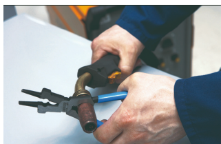
Demontaža in montaža šobe
