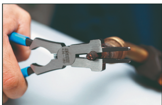
Demontaža in montaža notranje šobe
