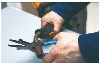
Снятие и установка сопла
