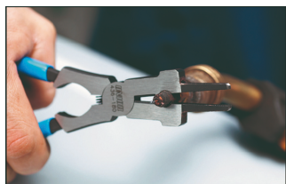
Удаление и установка жиклёра
