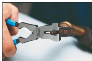
Demontatarea si montarea tubului de contact
