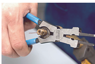
Demontare si montare a difuzorului izolant
