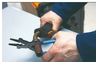
Usuwanie i montaż końcówki
