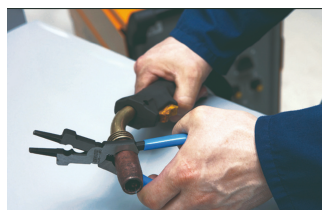
Отстранување и монтажа на бризгалка
