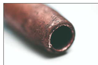
Чистење на бризгалка
