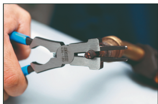
Rimozione e installazione della punta
