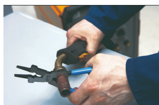
Fúvóka eltávolítása és rögzítése
