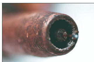
Uklanjanje nečistoće i ostatka vara sa iz unutrašnjosti mlaznice
