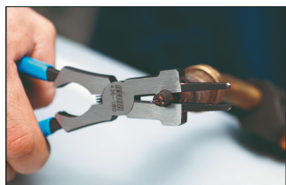
Démontage et remontage du tube contact
