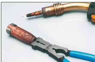
Nettoyage des éclaboussures sur la buse
