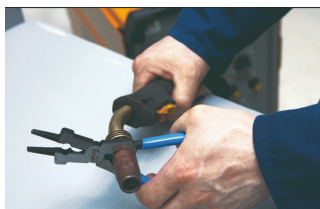
Postavljanje i demontaža mlaznice
