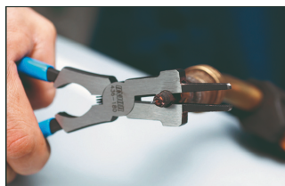
Postavljanje i demontaža mlaznice
