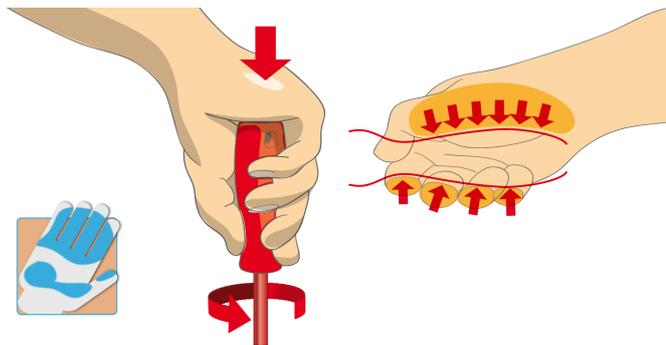
Große Handkontaktfläche = mehr Drehkraft
