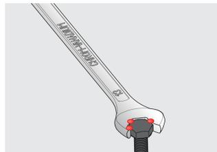
3 points d'appui augmentant la puissance de serrage.
