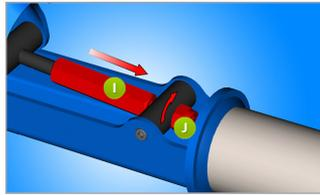
Schieben Sie die Stellmutter M8 (I) durch die Hebelführung und schrauben Sie mit Hilfe eines Schlüssels Gr. 13 darauf eine neue Sicherungsmutter M8 (J), wobei Sie mit einem anderen Schlüssel Gr. 13 die Stellmutter M8 gegenhalten müssen. Schrauben Sie die Sicherungsmutter M8 so, dass zwischen ihr und der Hebelführung noch etwas Spiel bleibt, um später die Stellmutter mit der Hand zu- und abschrauben zu können.
