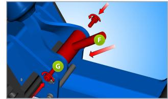
Schieben Sie zwischen den Blechteil des Griffes den neuen, kürzeren Griffhebel (F) und befestigen Sie diesen mit zwei Innensechskantschrauben M4 (G) in den Griff.
