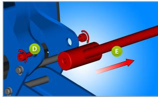
Schrauben Sie beide Innensechskantschrauben M4 (D) aus dem Griff und entfernen Sie den Griffhebel (E), der für das System mit der Schraube auch nicht mehr verwendet wird.
