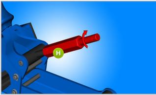
Schrauben Sie auf den Griffhebel ungefähr bis zur Hälfte die neue Stellmutter M8 (H).
