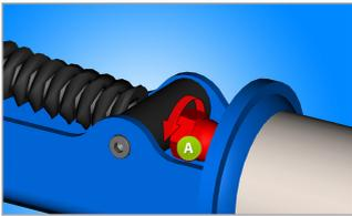
Schrauben Sie mit Hilfe eines Schlüssels Gr. 13 die Stellmutter M8 (A) aus dem Griffhebel. VORSICHT beim Abschrauben, die Feder ist gespannt und kann beim unvorsichtigen Abschrauben herauspringen.
