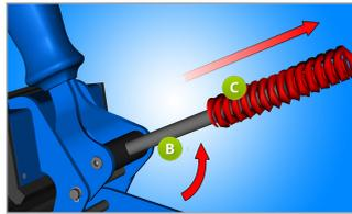
Schieben Sie den Griff in Richtung der Spannbacken und ziehen Sie hiermit den Griffhebel (B) heraus und entfernen Sie danach die Feder (C). Die Mutter und Feder werden für das System mit der Schraube nicht mehr verwendet.
