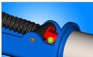
A l'aide d'une clé, dévisser l'écrou M8 (A) du levier de poignée. ATTENTION pendant le dévissage : le ressort est comprimé et risque de sortir intempestivement.
