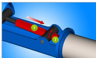
Insérer l'écrou de réglage M8 (I) dans le support pivotant. A l'aide d'une clé 13 mm, visser un nouvel écrou six pans M8 (J), tout en maintenant l'écrou de réglage avec une deuxième clé 13 mm. Laisser un peu de jeu entre l'écrou de blocage (J) et le support pivotant pour permettre de serrer ou de desserrer l'écrou de réglage.
