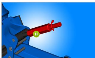
Visser l'écrou de réglage M8 (H) sur environ la moitié de la longueur du levier de poignée.
