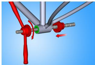
Pour enlever la cuvette de roulement du cadre du vélo, visser l'écrou jusqu'au point où l'extracteur n'a pas encore complètement extrait la cuvette du cadre. Répéter la même procédure de l'autre côté.
