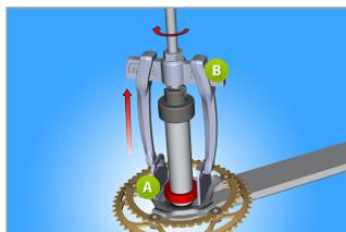
Для удаления подшипника из шатуна мы используем универсальный съёмник (B) вместе с расширителем для снятия подшипника (A).
