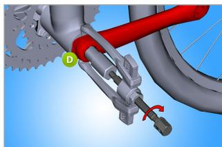
Для удаления карбонового шатуна Campagnolo® Power Torque используется та же процедура, что и для алюминиевого шатуна, за исключением того, что мы должны использовать более толстый пластмассовый протектор (D).
