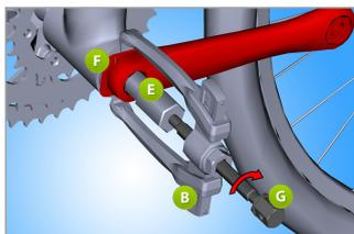
Для удаления алюминиевого шатуна Campagnolo® Ultra Torque мы используем тонкий плоский протектор (F), который мы надёжно закрепляем между шатуном и крышкой каретки. После этого мы вставляем удлинение штифта (E) в каретку и с помощью универсального съёмника (B) мы удаляем шатун, поворачивая винт (G) в направлении по часовой стрелке. Винт может поворачиваться с помощью гаечного ключа на 19 мм.
